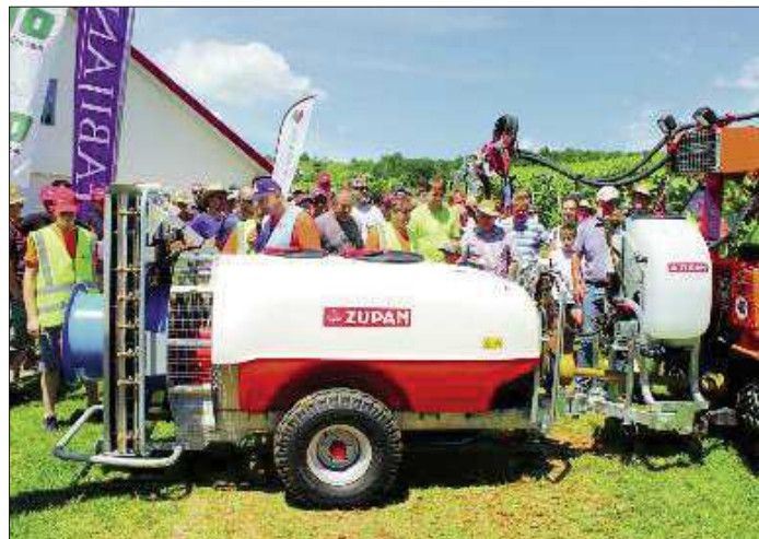
Veliko pozornosti je pritegnil Zupanov vlečeni pršilnik 800 DT-V. Izvedba je opremljena z brezžičnim tabličnim računalnikom, s pršilnikom, povezanim prek bluetootha. Ima tudi merilec hitrosti s pomočjo GPS-sistema. Tehnologija omogoča variabilno količino škropljenja glede na površino. Računalnik omogoča, da si doma sprogramiramo, na katerem delu parcele bolj ali manj škropimo oz. gnojimo.
