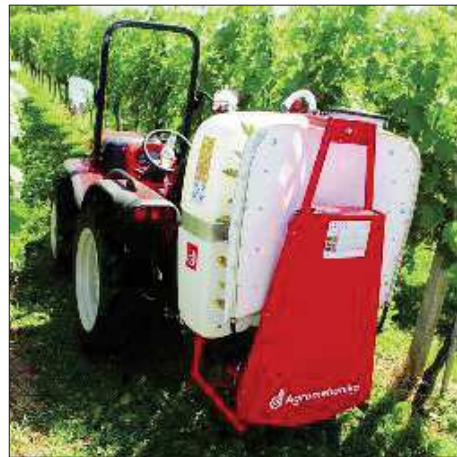
Nošeni pršilnik AGP 100 TN podjetja Agromehanike, pripet na traktor Antonio Carraro Tigr 4400 F
