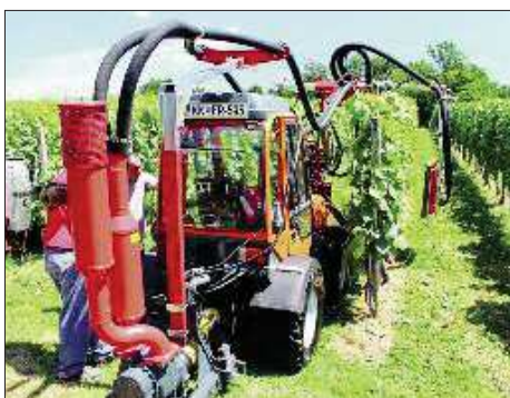
Defoliator je namenjen odstranjevanju listja v območju grozdja, ki je s tem bolj izpostavljeno soncu. Lažje je tudi varstvo pred boleznimi.
