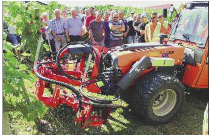
Na traktor Holder priključen pletvenik Tehnos, zadaj pa je bil priklopljen mulčer kladivar Tehnos robustne izdelave.
