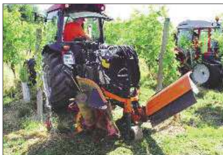
Berti Ecosprint, dvostranska ščetka z daljšimi nitkami (zastopnik Ascon), namenjen bolj delu v sadovnjakih, priključen na traktor McCormick
