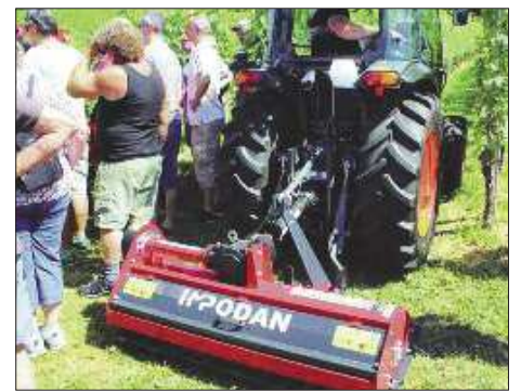
Mulčer Impodan, priključen na traktor Kubota
