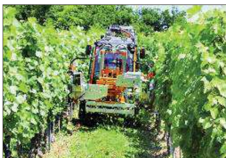
S priključkom za odstranjevanje listja je grozdje hitreje izpostavljeno bolj zračnim razmeram, kar omogoča lažje zatiranje boleznimi in škodljivcem ter lepše in bolj enakomerno doziranje.
